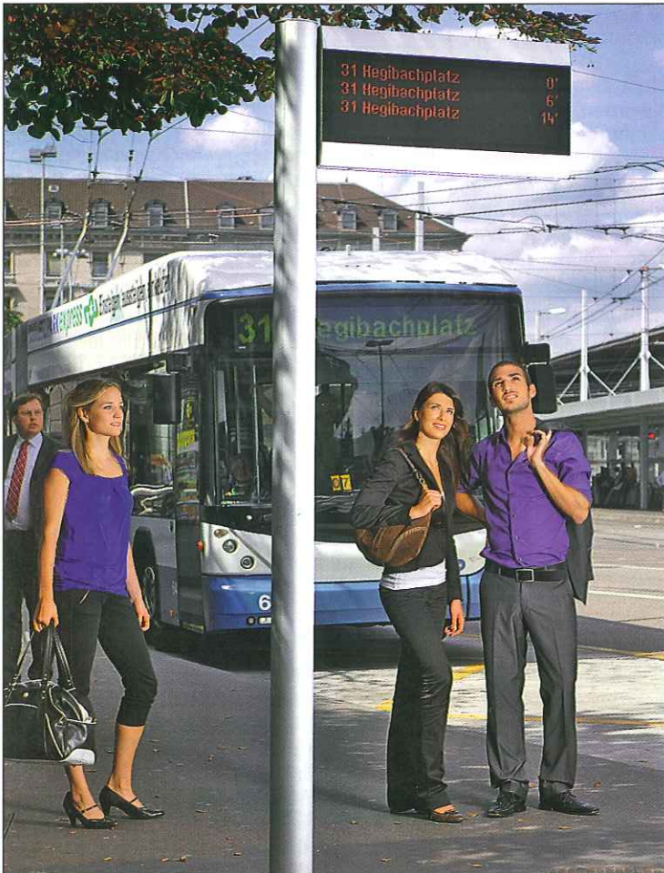
Abb. 1: Fahrgastinformation in Echtzeit erhöht die Attraktivität des öffentlichen Verkehrs für die Fahrgäste. Beispielsweise mit dem Haltestellenanzeiger Smartinfo von Trapeze ITS mit Text-to-Speech-Lösung für sehgeschwache Fahrgäste.
